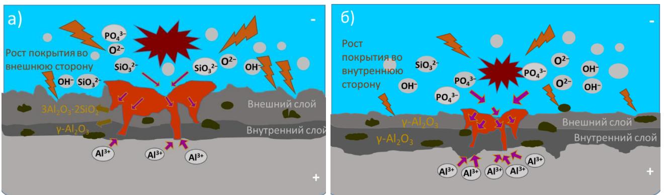
а) в электролите на основе Si; б) OH-, P-электролитов
