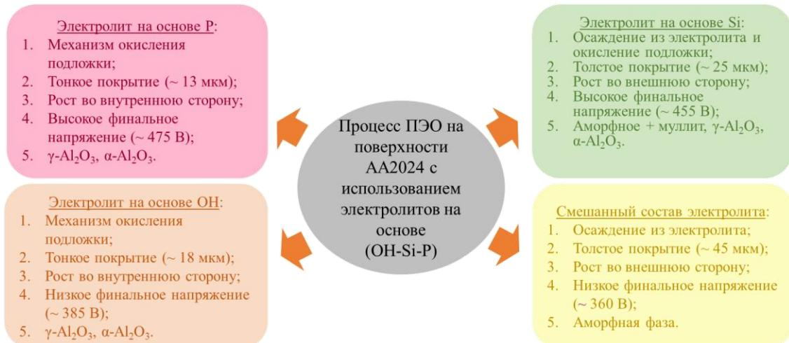
Рисунок 38 - Схематическая иллюстрация характеристик покрытий ПЭО, полученных в различных составах электролитов [12]
