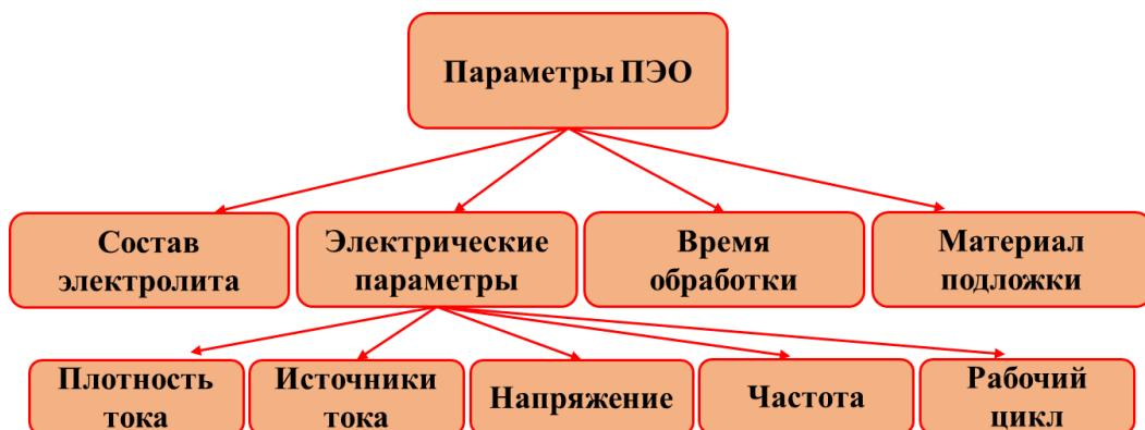
Рисунок 7 - Технологические параметры, влияющие на ПЭО процесс
